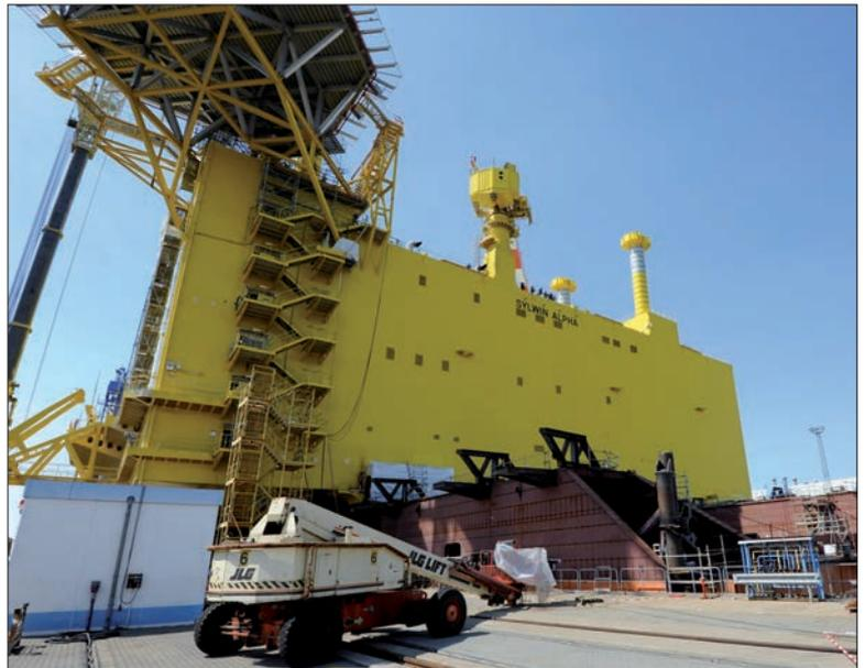
*Bild 2 (links): Das Oberdeck – links einer der bordeigenen Kräne. Rechts sind zwei der Beine zu erkennen, an denen sich die Plattform nach Erreichen der Zielposition hochzieht. Bild 3 (rechts): Die SylWin Alpha wurde auf einer Barge (im Bild rostrot) erbaut.*
